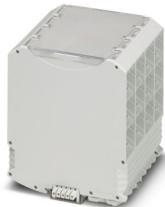
Tragschienengehäuse, Komplettgehäuse mit Metallfußriegel, hohe Bauform, ohne Lüftungsschlitz, Breite: 90,4 mm, Höhe: 99 mm, Tiefe: 113,65 mm, Farbe: lichtgrau (ähnlich RAL 7035), Querverbindung: Tragschienen-Busverbinder (optional), Polzahl Querverbindrer: 5
