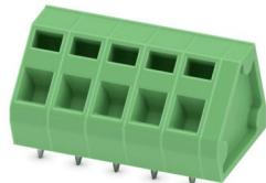
Leiterplattenklemme, Nennstrom: 16 A, Bemessungsspannung (III/2): 400 V, Nennquerschnitt: 1,5 mm<sup>2</sup>, Anzahl der Potenziale: 5, Anzahl der Reihen: 1, Polzahl pro Reihe: 5, Artikelfamilie: ZFKDS(A) 1,5, Rastermaß: 5,08 mm, Anschlussart: Zugfederanschluss, Montage: Wellenlöten, Anschlussrichtung Leiter/Platine: 45 °, Farbe: grün, Pin-Layout: Lineares Pinning, Pinlänge [P]: 3,5 mm, Anzahl der Lötpins pro Potenzial: 2, Verpackungsart: verpackt im Karton
