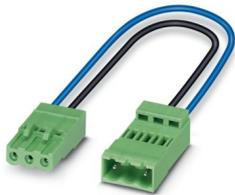
Konfektionierte Leiterplatten-Steckverbinder / Verbindungsleitung mit 2 Leiterplattensteckern, Bemessungsstrom: 9 A, Kopf 1: 3-polig, Rastermaß: 5,08 mm, Crimpanschluss, Stift, Leitung 1: Kabellänge: 0,33 m, Farbe: schwarz, blau, Kabeltyp:mPPE-Litze, Kopf 2: 3-polig, Rastermaß: 5,08 mm, Produktmerkmal: Leiterplattensteckverbinder für Smart Meter Gateways (SMGW), mPPE-Litze
