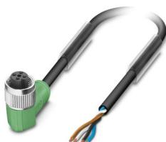
Sensor-/Aktor-Kabel, 4-polig, PVC, schwarz RAL 9005, freies Leitungsende, auf Buchse gewinkelt M12, Kodierung: A, Kabellänge: 3 m
