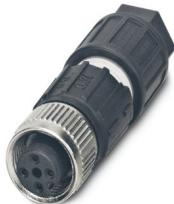
Steckverbinder, Universal, 4-polig, Buchse gerade M12, Kodierung: A, Schneidklemmanschluss, Rändelmaterial: Zinkdruckguss, vernickelt, Leitungsaußendurchmesser 3,5 mm ... 6 mm
