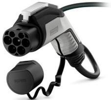
CHARX connect comfort, GB/T, AC-Ladeleitung, 16 A dauerhaft, 440 V AC, mit Fahrzeug-Ladestecker und offenem Leitungsende, Kabel: 5 m, schwarz, gerade, mit Schutzkappe, Gehäuse: schwarz, grau, PHOENIX CONTACT-Logo, GB/T 20234.2-2015, GB/T 18487.1-2015, zum Laden mit Wechselstrom (AC) von Elektrofahrzeugen (EV) mit GB/T Fahrzeug-Ladedosen
