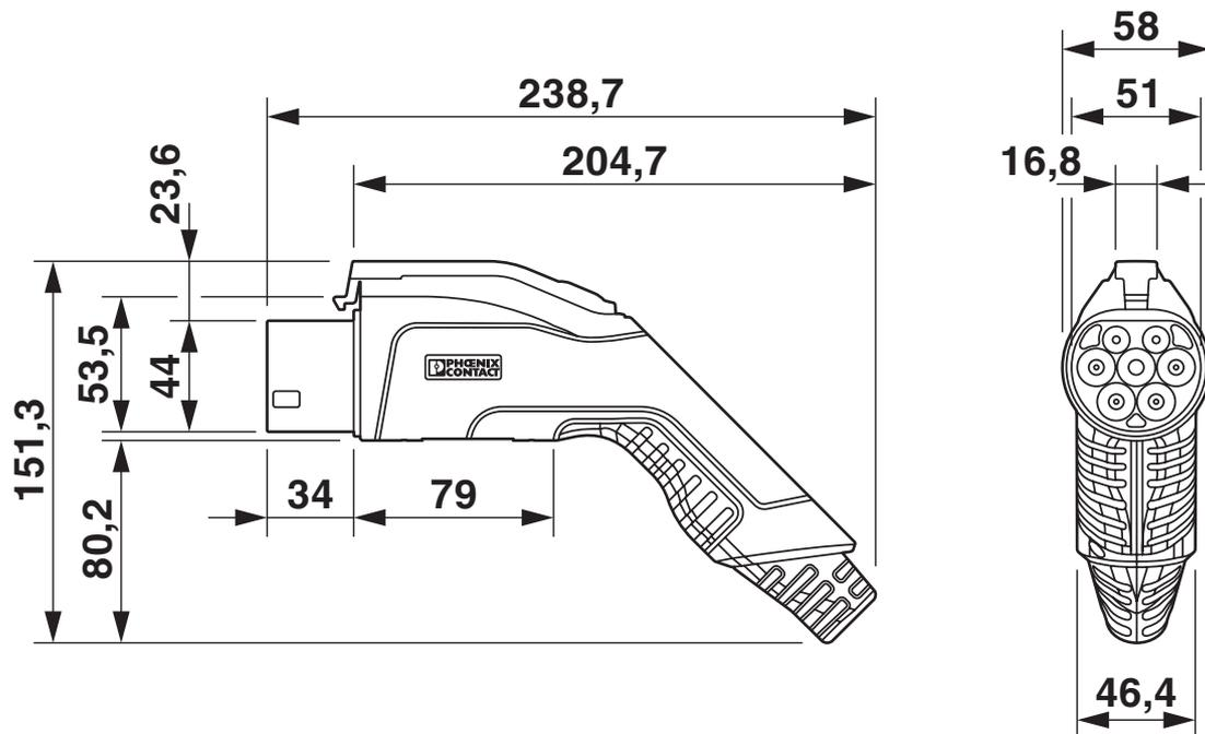
Stellen Sie sicher, dass der Fahrzeug-Ladestecker während der gesamten Ladepausenzeit in eine geeignete Ladesteckerhalterung gesteckt wird, die einen Schutz von mindestens IP24 nach IEC 61851-1 gewährleistet. Zur Erstellung einer solchen Ladesteckerhalterung verwenden Sie die Maße des Fahrzeug-Ladesteckers. Detailliertere Maßangaben finden Sie auch im Download-Bereich.
