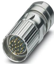
M23, Kabelsteckverbinder, Serie: CA, gerade, geschirmt: ja, Schraubverriegelung, Polzahl: 16+2+FE, Drehsinn: Standard, Kontaktart: Stift, Crimpanschluss, Kabeldurchmesserbereich: 4 mm ... 6 mm, Kodierung: N. Dieses Produkt befindet sich in einem Abkündigungsprozess. Für neue Projekte darf dieses Produkt nicht mehr berücksichtigt werden. Bitte wenden Sie sich für Alternativen an Ihren zuständigen Vertriebsmitarbeiter. Alternativartikel: 1629195
