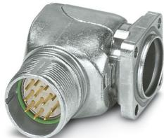
M23, Gerätesteckverbinder Vorderwand, Serie: CA, gewinkelt drehbar, geschirmt: ja, für Standard- und SPEEDCON-Verriegelung, Polzahl: 8+1, Drehsinn: Standard, Kontaktart: Stift, Lötanschluss, O-Ring axial, Kodierung: N. Dieses Produkt befindet sich in einem Abkündigungsprozess. Für neue Projekte darf dieses Produkt nicht mehr berücksichtigt werden. Bitte wenden Sie sich für Alternativen an Ihren zuständigen Vertriebsmitarbeiter.
