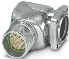
M23, Gerätesteckverbinder Vorderwand, Serie: CA, gewinkelt drehbar, geschirmt: ja, für Standard- und SPEEDCON-Verriegelung, Polzahl: 12, Drehsinn: Standard, Kontaktart: Stift, Crimpanschluss, O-Ring axial, Kodierung: N. Dieses Produkt befindet sich in einem Abkündigungsprozess. Für neue Projekte darf dieses Produkt nicht mehr berücksichtigt werden. Bitte wenden Sie sich für Alternativen an Ihren zuständigen Vertriebsmitarbeiter. Alternativartikel: 1628498
