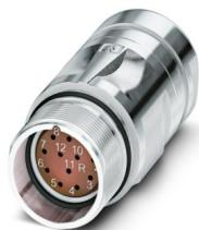
M23, Kupplungssteckverbinder, Serie: CA, gerade, geschirmt: ja, für Standard- und SPEEDCON-Verriegelung, Polzahl: 17, Drehsinn: Standard, Kontaktart: Buchse, Crimpanschluss, Kabeldurchmesserbereich: 10 mm ... 14,5 mm, Kodierung: N Alternativartikel: 1629109
