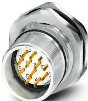
M23, Gerätesteckverbinder Hinterwand, Serie: CA, gerade, geschirmt: ja, für Standard- und SPEEDCON-Verriegelung, Polzahl: 7, Drehsinn: Standard, Kontaktart: Stift, Crimpanschluss, Axialdichtung, Kodierung: N. Dieses Produkt befindet sich in einem Abkündigungsprozess. Für neue Projekte darf dieses Produkt nicht mehr berücksichtigt werden. Bitte wenden Sie sich für Alternativen an Ihren zuständigen Vertriebsmitarbeiter.
