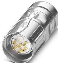
M23, Kabelsteckverbinder, Serie: CA, gerade, geschirmt: ja, SPEEDCON, Polzahl: 6, Drehsinn: Standard, Kontaktart: Stift, Crimpanschluss, Kabeldurchmesserbereich: 4 mm ... 6 mm, Kodierung: N. Dieses Produkt befindet sich in einem Abkündigungsprozess. Für neue Projekte darf dieses Produkt nicht mehr berücksichtigt werden. Bitte wenden Sie sich für Alternativen an Ihren zuständigen Vertriebsmitarbeiter.
