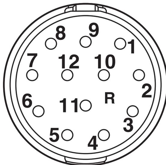
Kontaktkammernummerierung (Ansicht Steckseite) Buchse Gegenlauf
