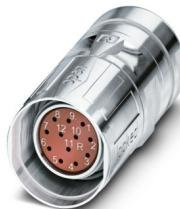
M23, Kabelsteckverbinder, Serie: CA, gerade, geschirmt: ja, SPEEDCON, Polzahl: 17, Drehsinn: Standard, Kontaktart: Buchse, Crimpanschluss, Kabeldurchmesserbereich: 4 mm ... 6 mm, Kodierung: N. Dieses Produkt befindet sich in einem Abkündigungsprozess. Für neue Projekte darf dieses Produkt nicht mehr berücksichtigt werden. Bitte wenden Sie sich für Alternativen an Ihren zuständigen Vertriebsmitarbeiter. Alternativartikel: 1629207
