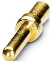
Crimpkontakt, Stift, gedreht, Kontaktdurchmesser: 2 mm, Anschlussquerschnitt: 1,5 mm<sup>2</sup> ... 2,5 mm<sup>2</sup>, Material Kontakt: CuZn, Alternativprodukt nach RoHS II ohne Ausnahme 6c (Pb < 0,1 %)
