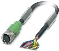
Sensor-/Aktor-Kabel, 17-polig, PVC, schwarz RAL 9005, freies Leitungsende, auf Buchse gerade M12 SPEEDCON, Kodierung: A, Kabellänge: 1,5 m
