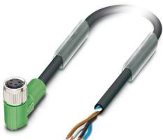
Sensor-/Aktor-Kabel, 4-polig, PUR halogenfrei, schwarzgrau RAL 7021, freies Leitungsende, auf Buchse gewinkelt M8, Kodierung: A, Kabellänge: 5 m
