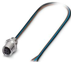
Gerätesteckverbinder Vorderwand, 3-polig, Buchse, gerade, M5, A-Kodierung, Einzellitzen, Kabellänge: 0,5 m, 0,14 mm<sup>2</sup>, TPE-Litze
