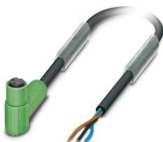
Sensor-/Aktor-Kabel, 3-polig, PUR halogenfrei, schwarzgrau RAL 7021, freies Leitungsende, auf Buchse gewinkelt M8 Snap-in, Kodierung: A, Kabellänge: 5 m
