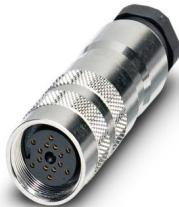
Anschlussbuchse M16, 14-polig, mit Lötanschluss, frei konfigurierbar, gerade, für Leitungsdurchmesser 6,0 mm ... 8,0 mm
