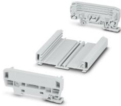
Profilgehäuse (PVC), Montageart: Tragschienenmontage, Maße auf Tragschiene: Breite: 103,8 mm, Höhe: 92,3 mm, Tiefe: 39,45 mm, einschl. 2 Seitenelemente (PA), Farbe: lichtgrau (7035), für Leiterplatten mit Breite: 72 mm, Länge: 100 mm, Leiterplattenfläche: 5650 mm<sup>2</sup>
