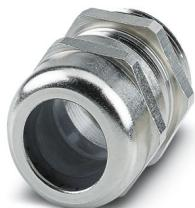
Kabelverschraubung, Material Verschraubung: Messing, vernickelt, Anwendung: Standard, Kabelaußendurchmesser 18 mm ... 25 mm, Schirmung: nein, Anschlussgewinde: M40 x 1,5, Farbe: silberfarben, mit O-Ring
