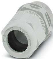
Kabelverschraubung, Material Verschraubung: PA, Anwendung: Standard, Kabelaußendurchmesser 16 mm ... 28 mm, Schirmung: nein, Anschlussgewinde: M40 x 1,5, Farbe: lichtgrau RAL 7035
