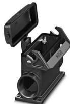
Sockelgehäuse B24, mit Längsbügel, Material: PA 6.6-FR, Material Schutzdeckel: PC, Kabelabgänge: 2, seitlich, 2x M25, Höhe: 84 mm, Kabelverschraubung: ohne, Schutzdeckel: ja, Standard, inklusiv 2x Reduzieradapter
