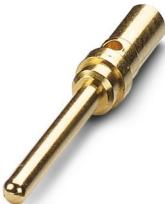
D-SUB-Crimpkontakt, Serie: HC-M-DSUB-C, Stift, gedreht, Kontaktdurchmesser: 1 mm, Bemessungsstrom: 5 A, Anschlussquerschnitt: 0,08 mm<sup>2</sup> ... 0,12 mm<sup>2</sup>, AWG 28...24 , Material Kontakt: Metall
