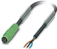
Sensor-/Aktor-Kabel, 3-polig, PUR halogenfrei, schwarzgrau RAL 7021, freies Leitungsende, auf Buchse gerade M8 Snap-in, Kodierung: A, Kabellänge: 2 m
