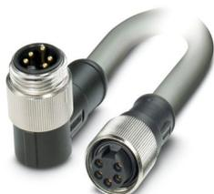
Bussystem-Kabel, DeviceNet™, 5-polig, PVC, grau RAL 7001, Stecker gewinkelt 7/8"-16UNF, Kodierung: A, auf Buchse gerade 7/8"-16UNF, Kabellänge: 5 m, Steckverbinder ungeschirmt
