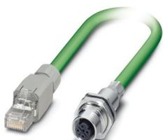
Konfektioniertes PROFINET-Kabel, CAT 5e, geschirmt, Sternvierer, AWG 22 flexibel (7-drähtig), RAL 6018 (gelbgrün), RJ45-Stecker/IP20 auf M12-Einbaubuchse, Hinterwand-/Schraubmontage mit M16-Gewinde, Line, Länge: 2 m
