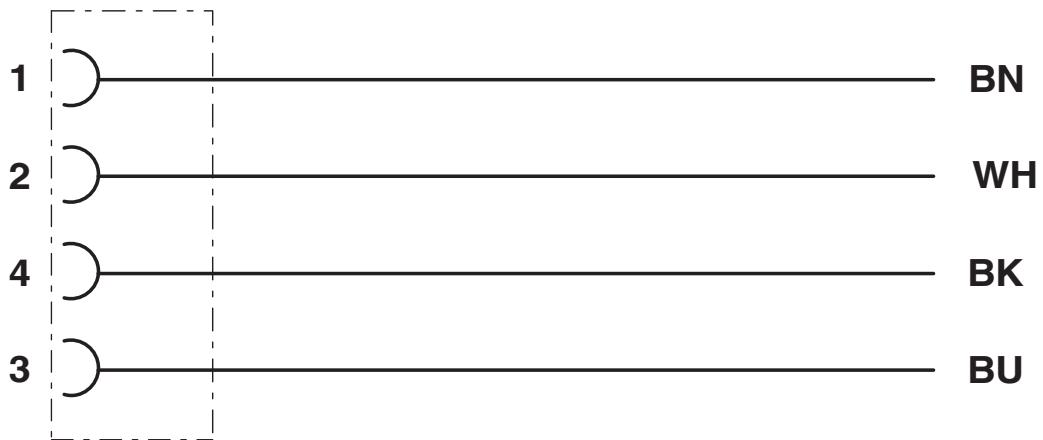
Kontaktbelegung der M8-/M12-Stecker/Buchsen
