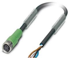
Sensor-/Aktor-Kabel, 4-polig, PVC, schwarz RAL 9005, freies Leitungsende, auf Buchse gerade M8, Kodierung: A, Kabellänge: 3 m
