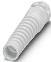
Kabelverschraubung, Material Verschraubung: PA, Anwendung: Standard, Kabelaußendurchmesser 4,5 mm ... 10 mm, Schirmung: nein, Anschlussgewinde: M16 x 1,5, Farbe: lichtgrau RAL 7035, mit Knickschutz
