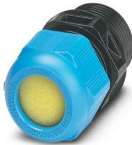
Kabelverschraubung, Material Verschraubung: PA, Anwendung: Ex, Kabelaußendurchmesser 10 mm ... 17 mm, Schirmung: nein, Anschlussgewinde: M25 x 1,5, Farbe: schwarz/blau, mit Flachdichtung
