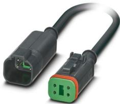
Sensor-/Aktor-Kabel, 4-polig, PUR halogenfrei, schwarzgrau RAL 7021, Stecker gerade DEUTSCH DT04-4P Clipverriegelung, Kodierung: A, Beschaltung: unbeschaltet, auf Buchse gerade DEUTSCH DT06-4S Clipverriegelung, Beschaltung: unbeschaltet, Kabellänge: 1,5 m
