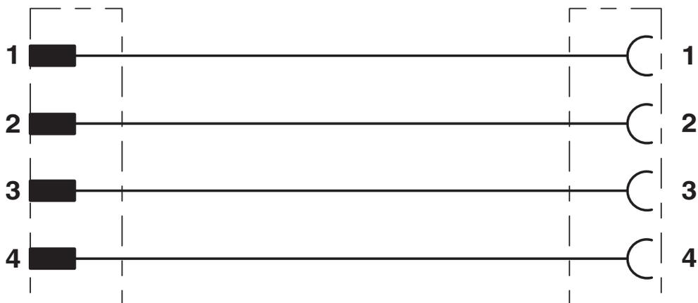
Kontaktbelegung der DEUTSCH-Steckverbinder
