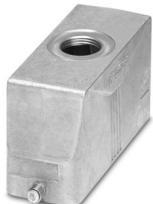
Tüllengehäuse B24, für Längsbügel, Material: Aluminiumdruckguss, seewasserbeständig, Kabelabgänge: 1, gerade, 1x M25, Höhe: 60 mm, Kabelverschraubung: ohne, Standard
