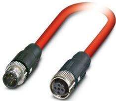
Netzwerkkabel, Sercos CAT5 (100 MBit/s), 4-polig, PVC/PVC, verkehrsrot RAL 3020, geschirmt, Stecker gerade M12 SPEEDCON, Kodierung: D / IP67, auf Buchse gerade M12 SPEEDCON, Kodierung: D / IP67, Kabellänge: 10 m
