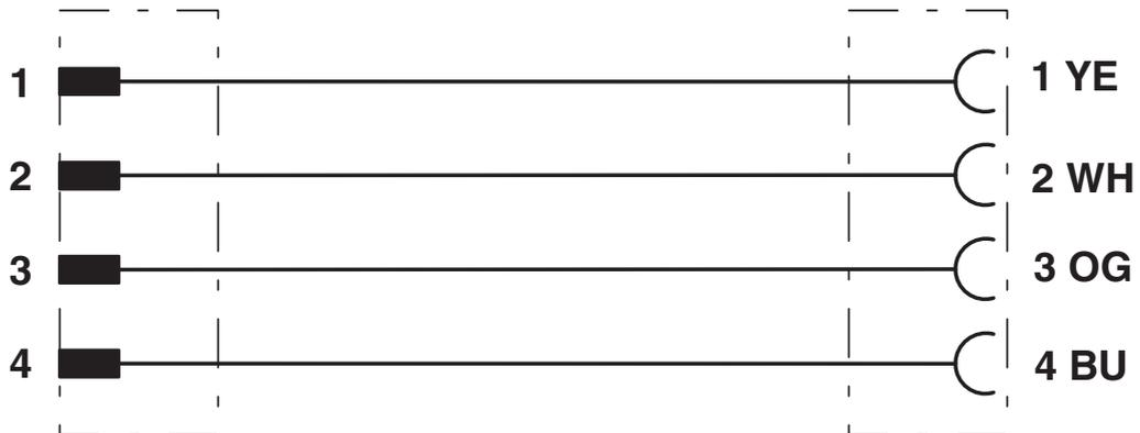
Kontaktbelegung des M12-Steckers und der M12-Buchse
