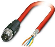
Netzkabel, Sercos CAT5 (100 MBit/s), 4-polig, PVC/PVC, verkehrsrot RAL 3020, geschirmt, Stecker gerade M12 SPEEDCON, Kodierung: D / IP67, auf freies Leitungsende, Kabellänge: 10 m
