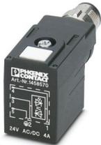
Ventilstecker, 3-polig, Stecker gewinkelt M12, Kodierung: A, auf Ventilstecker BI (11 mm), mit 1 LED, Beschaltung: Z-Diode, Steckgesicht des Ventilsteckers um 180° gedreht
