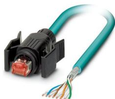
Konfektioniertes Ethernet-Kabel, geschirmt, 4-paarig, AWG 26 flexibel (7-drähtig), RAL 5021 (wasserblau), RJ45-Stecker/IP67, schwarz auf freies Leitungsende, Line, Länge 5 m
