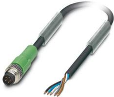
Sensor-/Aktor-Kabel, 5-polig, PUR halogenfrei, schwarzgrau RAL 7021, Stecker gerade M8, Kodierung: B, auf freies Leitungsende, Kabellänge: 5 m
