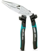
**Spitzzange**, abgewinkelte Form, mit Öffnungsfeder und Arretierung, feingezahnte Greiffläche, Abisoliermöglichkeit für 1,5 mm<sup>2</sup> und 2,5 mm<sup>2</sup>, integrierter Ringschlüssel M8 - M10, VDE 1000 V AC/1500 V DC geprüft
