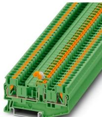
Messertrennklemme, Nennspannung: 400 V, Nennstrom: 16 A, Anschlussart: Push-in-Anschluss, Bemessungsquerschnitt: 2,5 mm<sup>2</sup>, Querschnitt: 0,14 mm<sup>2</sup> - 4 mm<sup>2</sup>, Montage: NS 35/7,5, NS 35/15, Farbe: grün
