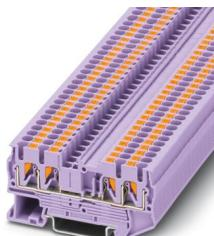
Durchgangsklemme, Nennspannung: 800 V, Nennstrom: 24 A, Anzahl der Anschlüsse: 4, Anschlussart: Push-in-Anschluss, Bemessungsquerschnitt: 2,5 mm<sup>2</sup>, Querschnitt: 0,14 mm<sup>2</sup> - 4 mm<sup>2</sup>, Montageart: NS 35/7,5, NS 35/15, Farbe: violett
