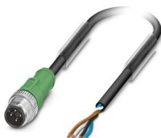
Sensor-/Aktor-Kabel, 4-polig, PUR halogenfrei, schwarzgrau RAL 7021, Stecker gerade M12, Kodierung: A, auf freies Leitungsende, Kabellänge: 0,285 m, freies Ende= 70 mm, Adern 3 mm, abisoliert und verzinkt
