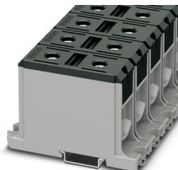
Hochstromklemme, Nennspannung: 1000 V, Nennstrom: 290 A, Anzahl der Anschlüsse: 2, Polzahl: 1, Anschlussart: Schraubanschluss, Bemessungsquerschnitt: 150 mm<sup>2</sup>, Querschnitt: 35 mm<sup>2</sup> - 150 mm<sup>2</sup>, Bemessungsquerschnitt: 150 mm<sup>2</sup>, Querschnitt: 35 mm<sup>2</sup> - 150 mm<sup>2</sup>, Montageart: NS 35/15, NS 35/7,5, Farbe: schwarz
