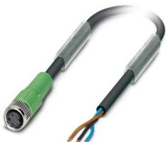
Sensor-/Aktor-Kabel, 3-polig, PUR halogenfrei, schwarzgrau RAL 7021, freies Leitungsende, auf Buchse gerade M8, Kabellänge: 10 m
