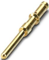
Crimpkontakt, Stift, gedreht, Kontakt durchmesser: 1 mm, Anschlussquerschnitt: 0,14 mm<sup>2</sup> ... 0,34 mm<sup>2</sup>, AWG 26...22, Material Kontakt: CuZn
