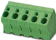
Leiterplattenklemme, Nennstrom: 76 A, Bemessungsspannung (III/2): 1000 V, Nennquerschnitt: 16 mm<sup>2</sup>, Anzahl der Potenziale: 5, Anzahl der Reihen: 1, Polzahl pro Reihe: 5, Artikelfamilie: SPTA 16/, Rastermaß: 15 mm, Anschlussart: Push-in-Federanschluss, Montage: Wellenlöten, Anschlussrichtung Leiter/Platine: 60 °, Farbe: grün, Pin-Layout: Zick-Zack-Pinning W, Pinlänge [P]: 4,1 mm, Anzahl der Lötspins pro Potenzial: 3, Verpackungsart: verpackt im Karton
