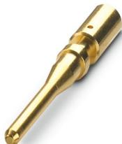
Crimpkontakt, Stift, gedreht, Kontakt durchmesser: 1,5 mm, Anschlussquerschnitt: 2,5 mm<sup>2</sup> ... 2,5 mm<sup>2</sup>, AWG 14...14, Material Kontakt: CuZn
