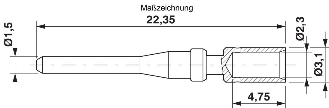
Crimpkontakt, Durchmesser: 1,5 mm
