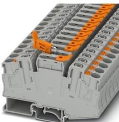
Messertrennklemme, Nennspannung: 1000 V, Nennstrom: 32 A, Anschlussart: Push-in-Anschluss, Bemessungsquerschnitt: 6 mm<sup>2</sup>, Querschnitt: 0,5 mm<sup>2</sup> - 10 mm<sup>2</sup>, Montage: NS 35/7,5, NS 35/15, NS 32, Farbe: grau
