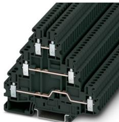
Mehrstockklemme, Nennspannung: 500 V, Nennstrom: 19 A, Anschlussart: Schraubanschluss, Bemessungsquerschnitt: 2,5 mm<sup>2</sup>, Querschnitt: 0,14 mm<sup>2</sup> - 4 mm<sup>2</sup>, Montageart: NS 35/7,5, NS 35/15, Farbe: schwarz
