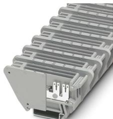
Durchgangsklemme, Nennspannung: 800 V, Nennstrom: 30 A, Anzahl der Anschlüsse: 6, Polzahl: 1, Anschlussart: Flachsteckanschluss, 1. Etage, Querschnitt: 0,5 mm<sup>2</sup> - 6 mm<sup>2</sup>, Montageart: NS 35/7,5, NS 35/15, Farbe: grau
